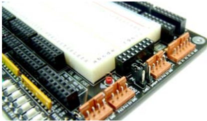
<그림6> P40, P41, P44, P45번 포트를 사용하려면, 그림과 같이 점퍼 Cap을 벗겨 놓으셔야 합니다.
